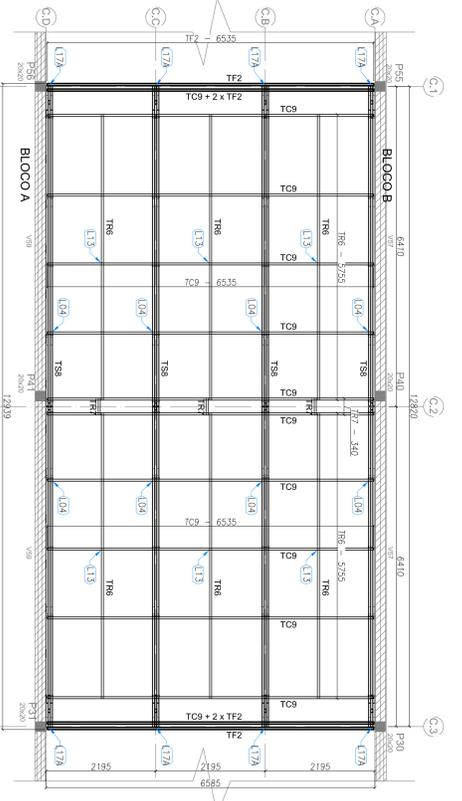
1 BLOCO C - PLANTA DE COBERTURA - VIGAS DE APOIO, TESOURAS, MANGUEIRAS E CONTRAVENTAMENTOS
